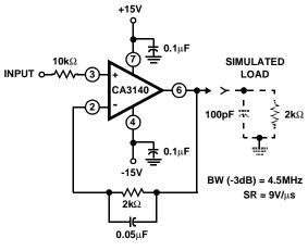
**FIGURE 28A. TEST CIRCUIT**
